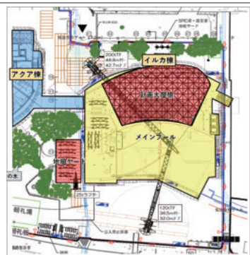
図4 屋根鉄骨 建方計画図
